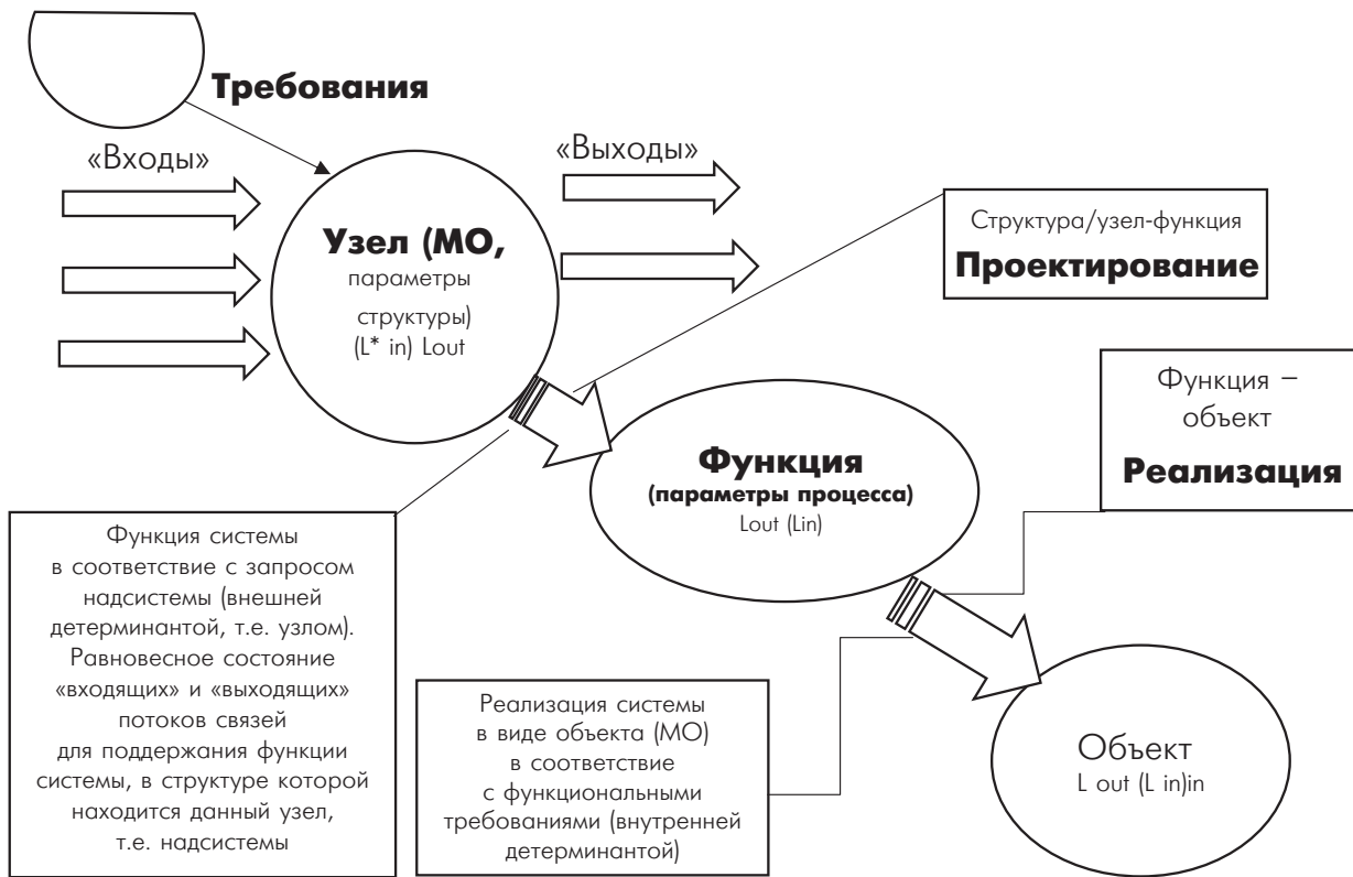
Рис. 2. Принцип системного подхода: Узел-Функция-Объект *L – связь/поток; Lineout, Linein – линейный выход и вход, соответственно
