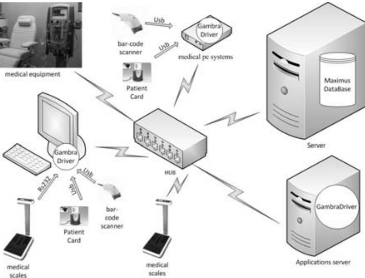
**Рис. 7. Сбор информации с оборудования с помощью модуля Maximus-Driver**
